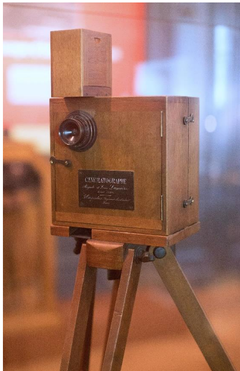
Slika 12. Cinématographe Lumière na Institutu Lumière , Francuska. Takve kamere nisu imale ugrađene uređaje za snimanje zvuka.
